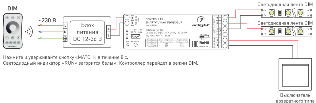
Рисунок 1. Схемы подключения контроллера SMART-TUYA-WIFI-MIX-SUF
