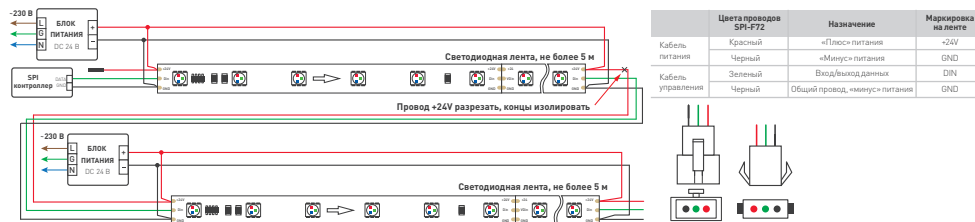
Схема 2. Подключение нескольких светодиодных лент SPI-F72 с двух сторон с использованием SPI-контроллера с одним выходным портом и отдельных блоков питания
