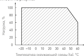
Рис. 1. Максимальная допустимая нагрузка, % от мощности источника
