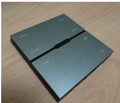
Рис. 3. Панель управления Smart Switch
