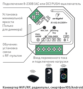
Рис. 1. Назначение кнопок и входов подключения.
